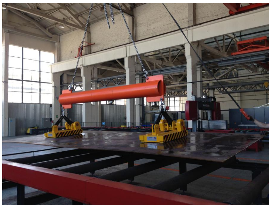
Фото №7. Использование магнитных траверс с самозахватывающим механизмом ускоряет
