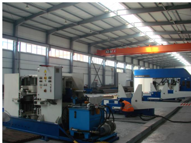
Фото №51. В состав линии входит станция сборки, сварки, кантователь на 180° и станция правки «грибовидности» полок.
