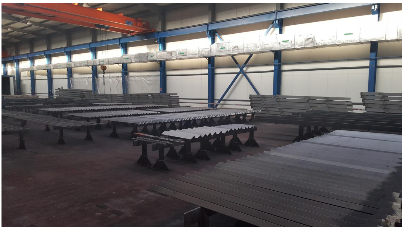
Фото №47. Раскладка отправочных марок в цехе окраски для грунтования.
