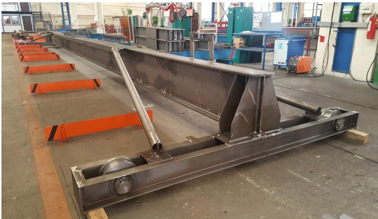
Фото №51. Металлоконструкции мостового крана.
