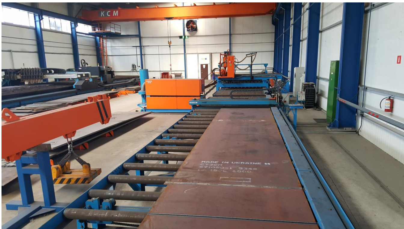
Фото №51. Максимальная длина состыкованного листа до 15 000 мм.
