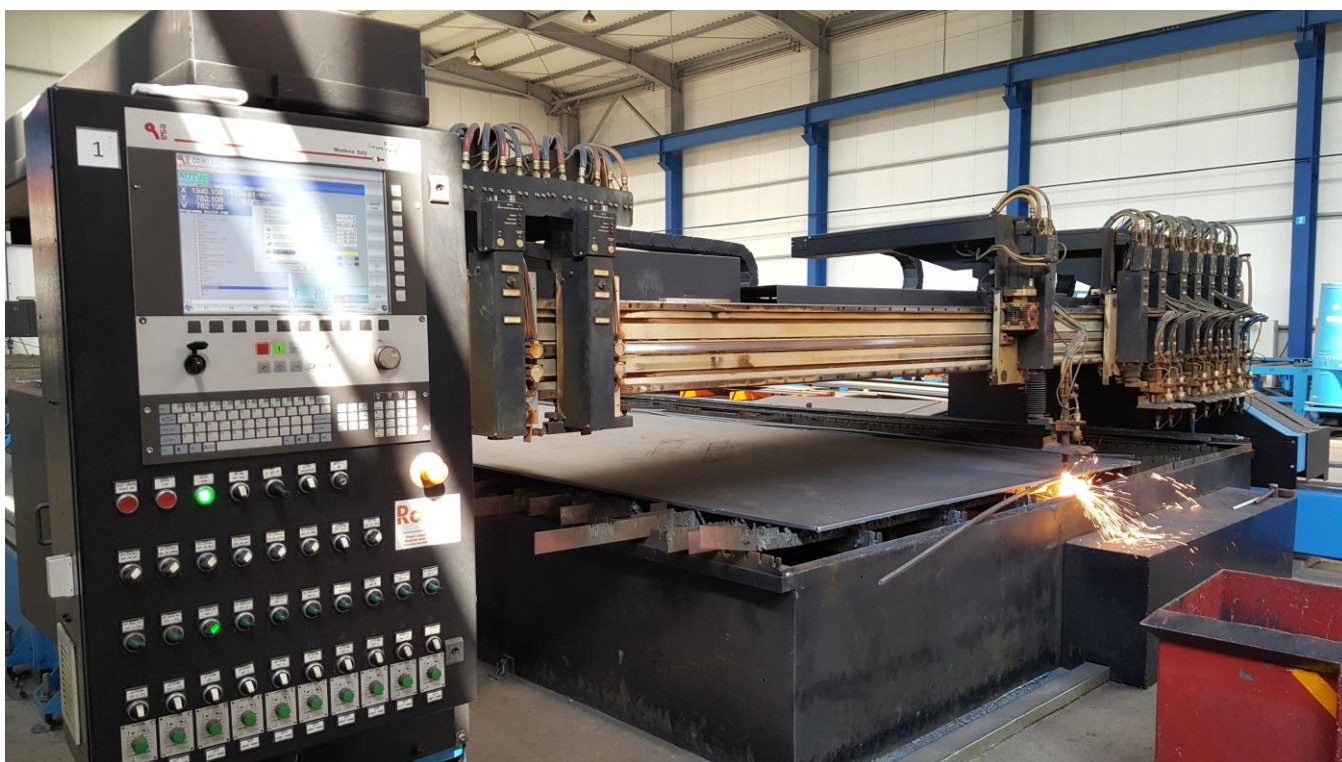
Фото №51. Ширина стола газовой резки позволяет укладывать два листа шириной 2000 мм параллельно друг другу для их одновременной резки.
