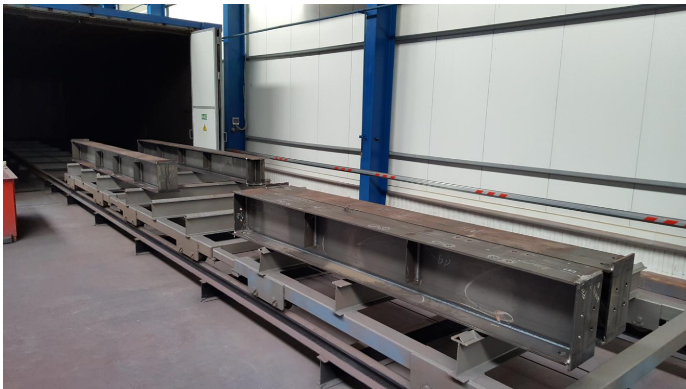
Фото №51. Загрузка дробеструйной камеры осуществляется с помощью рельсовой передаточной тележки.
