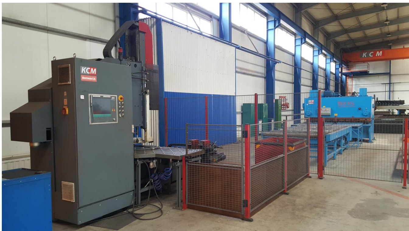
Фото №51. Машина сверления листовой заготовки размещена в цеху рядом с гильотиной и плазменной резкой
