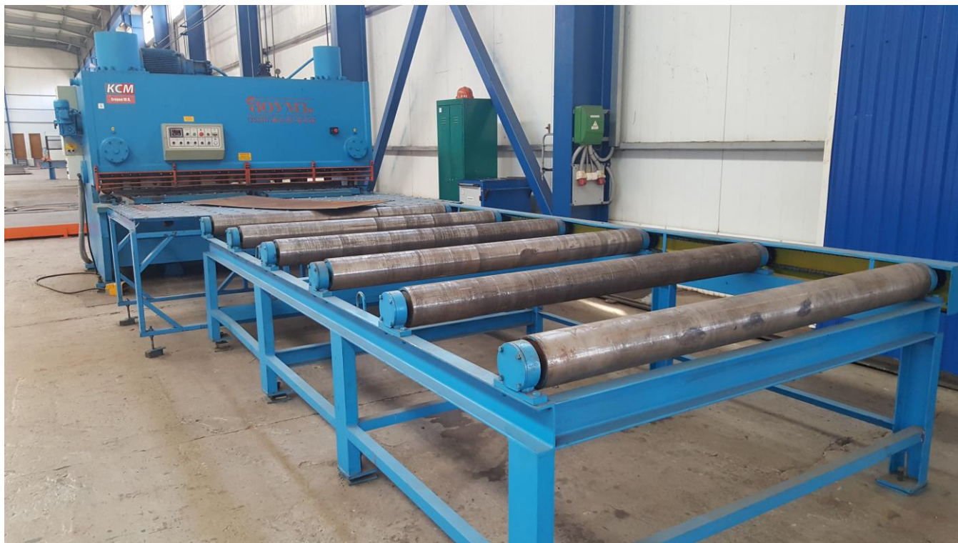
Фото №51. Гидравлическая гильотина НГ20Г.01
