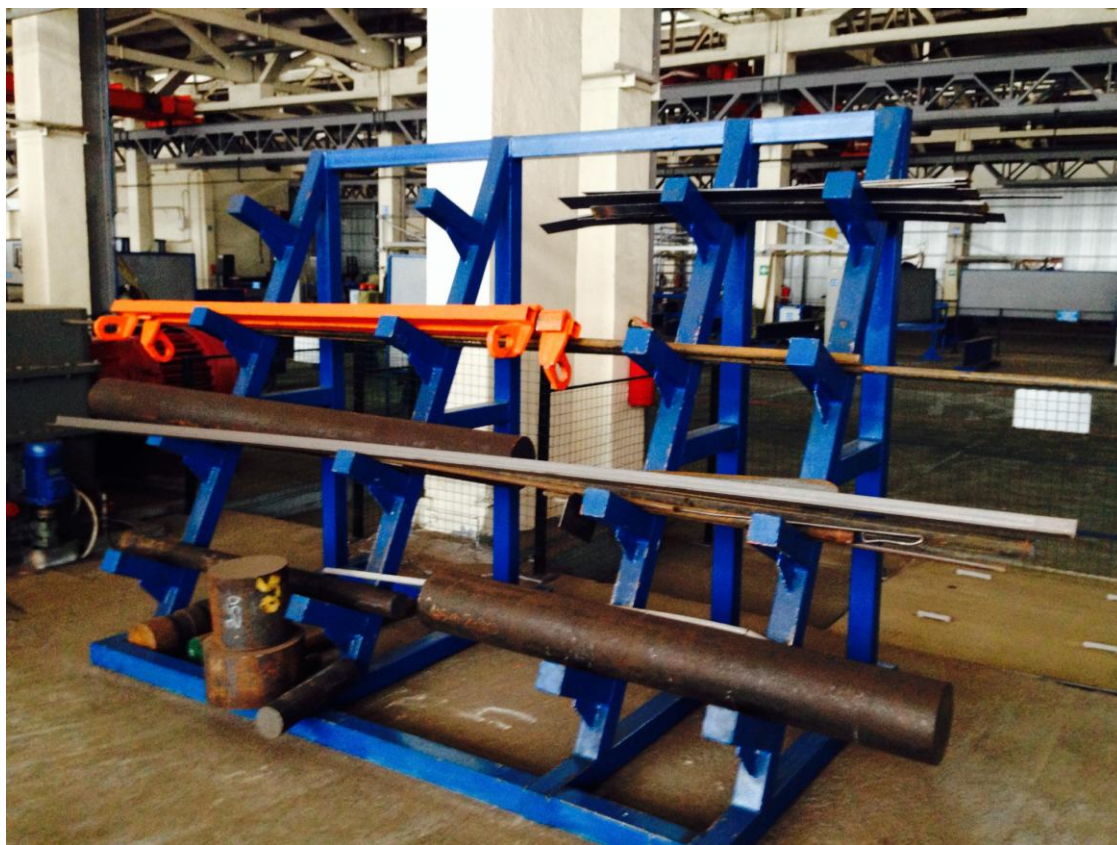
Фото №14. Стеллажи для хранения делового отхода возле ленточнопильного станка.
