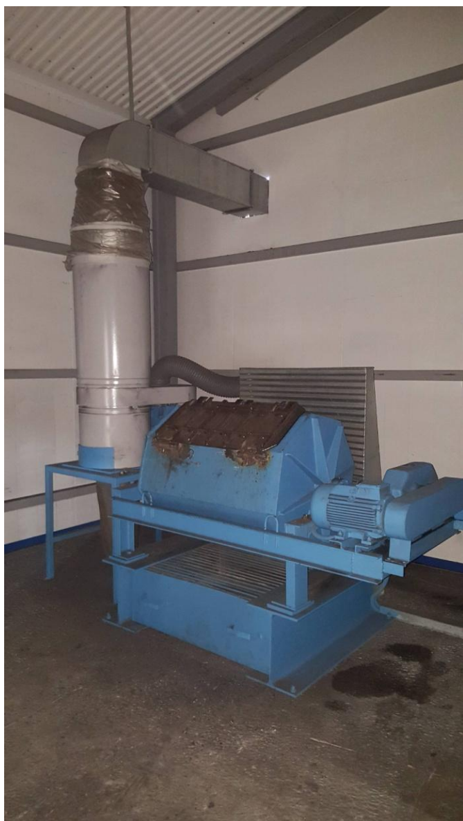
Фото №51. Галтовочный барабан БГ – 0,5
