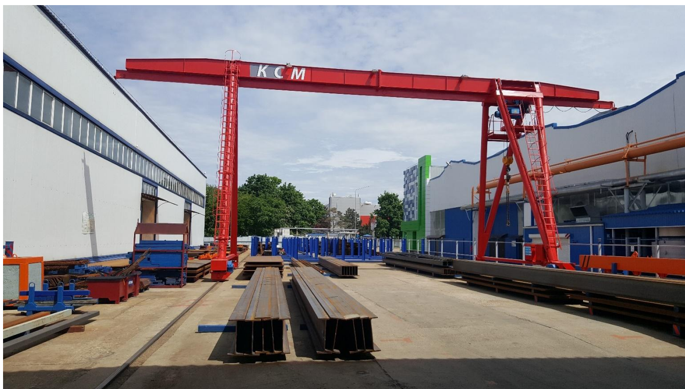
Фото №4. Подготовленные к отгрузке в цех пакеты металлопрофилей.
