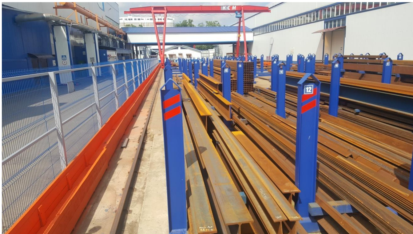
Фото №3. Стеллажи-кассеты для хранения металлопроката по видам профилей и маркам сталей
