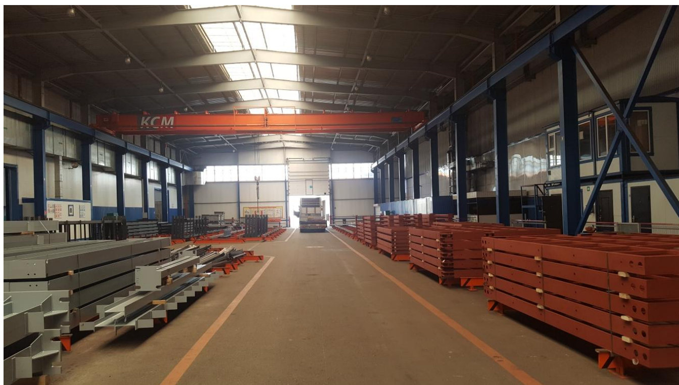
Фото №51. Участок упаковки, маркировки и отгрузки металлоконструкций.
