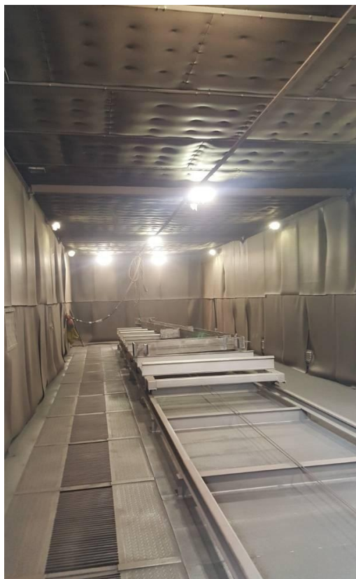
Фото №52. Дробеструйная камера оборудована системой автоматического сбора и рекуперации дроби.
