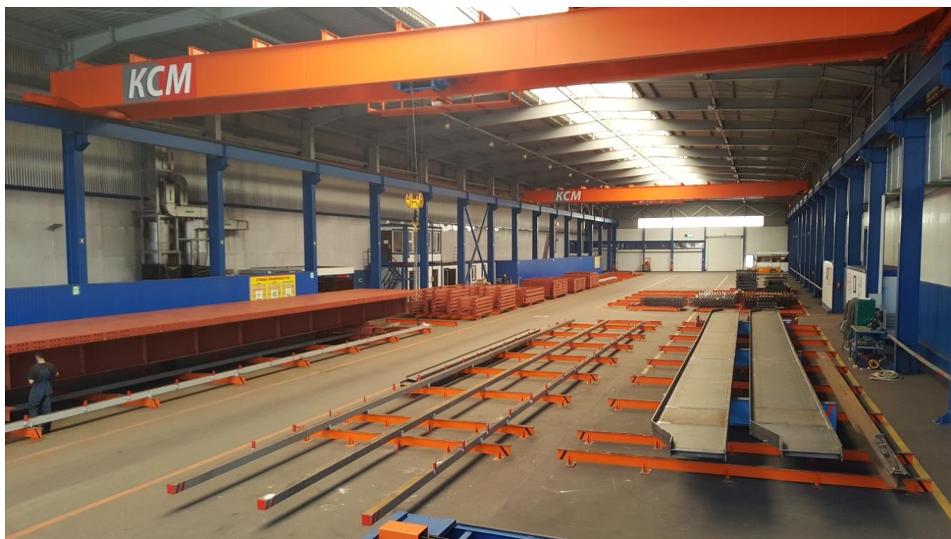
Фото №38. Участок сборки мостовых конструкций позволяет осуществлять сборку и обварку 4-х хребтовых балок одновременно.
