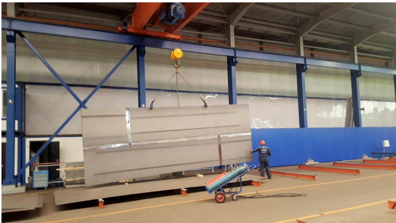
Фото №36. Перемещение негабаритной листовой заготовки размером 3200 x 16 000 мм с помощью кулачковых захватов.
