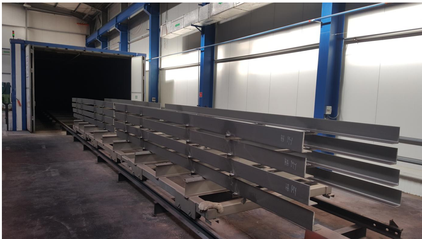
Фото №10. Дробеструйная обработка сварных швов и удаление следов ржавчины и сварочных брызг.
