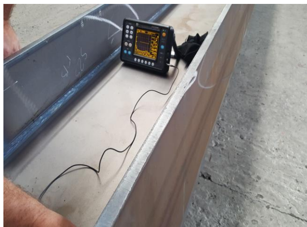
Фото №10. Сварные швы проверяются ультразвуковым дефектоскопом А1214.
