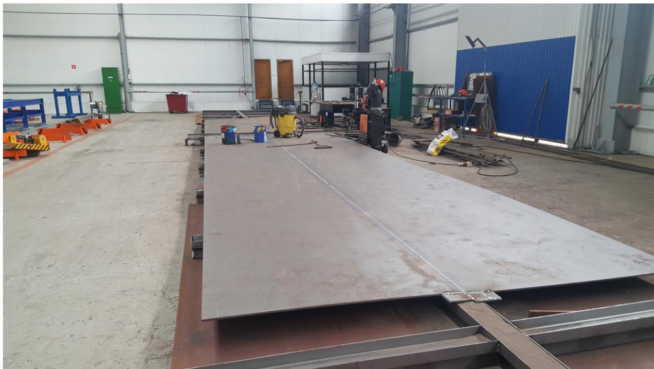
Фото №51. Сварка 4-х листов сварочным трактором на флюсовой подушке.
