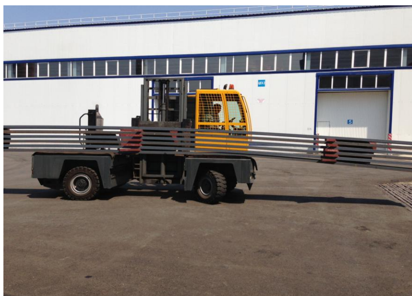
Фото №6. Пакет сортового проката вилочным погрузчиком перемещается в заготовительный цех
