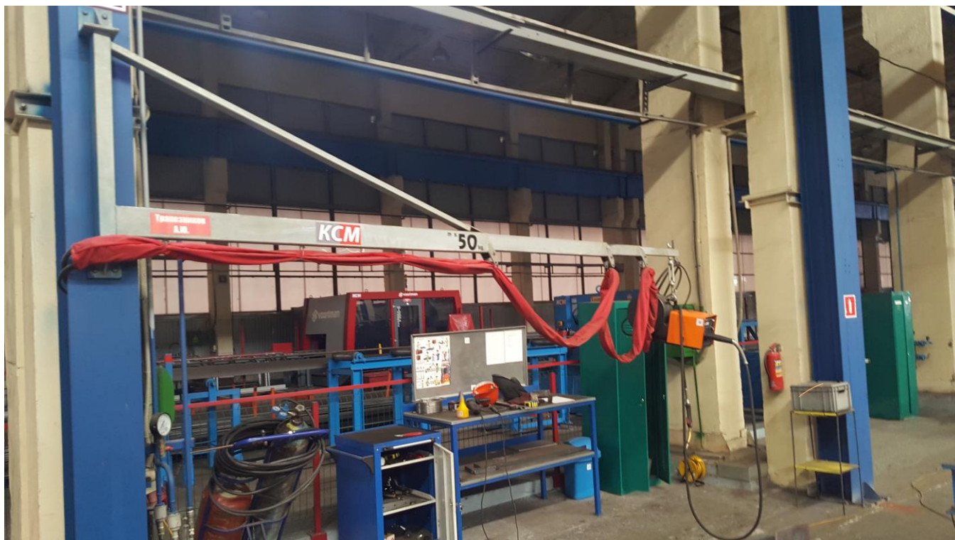
Фото №24. Каждое рабочее место (пост) в цеху оборудован выдвигной поворотной консолью с подающим механизмом на конце.
