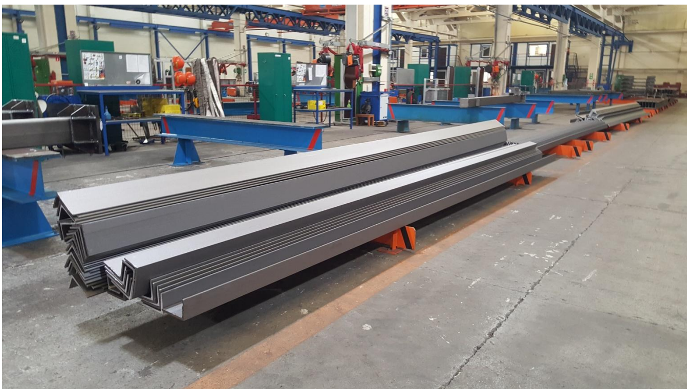
Фото №21. Заготовка укладывается перед каждым рабочим местом слесаря-сборщика.
