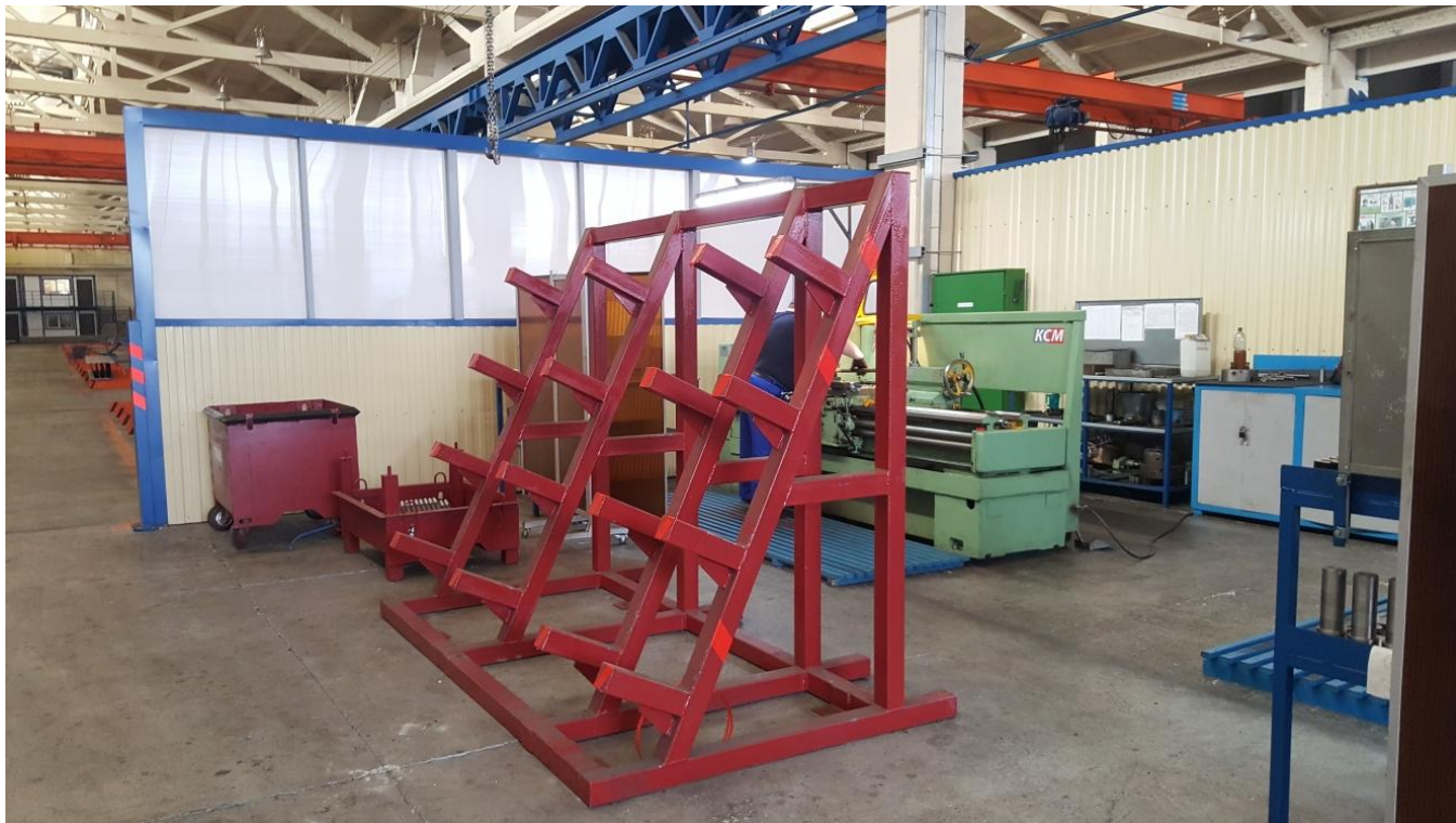
Фото №13. Стеллажи для хранения металлопроката в механическом участке.
