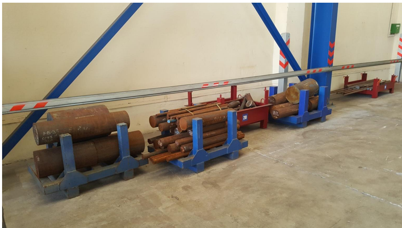
Фото №12. Стеллажи для хранения металлопроката в механическом участке.
