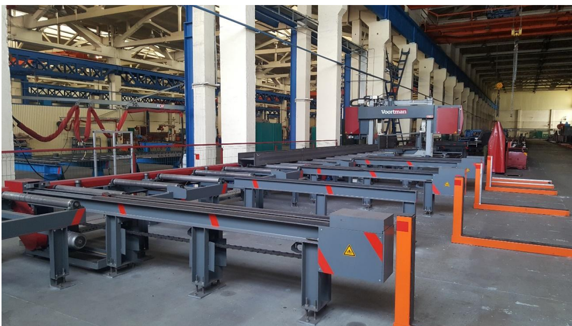
Фото №51. Линия Voortman VB-1050 предназначена для автоматической резки сортового и фасонного проката
