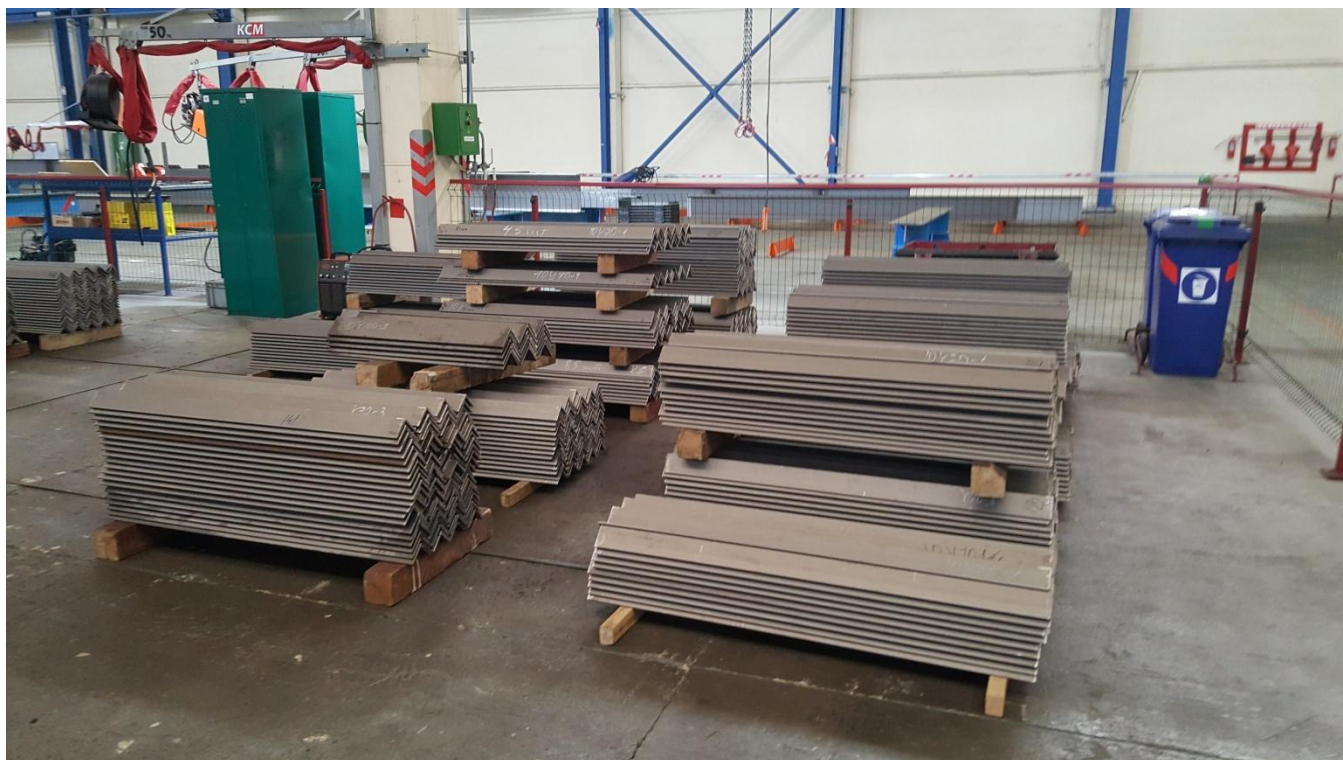
Фото №16. Временное хранение заготовок из фасонного и сортового проката
