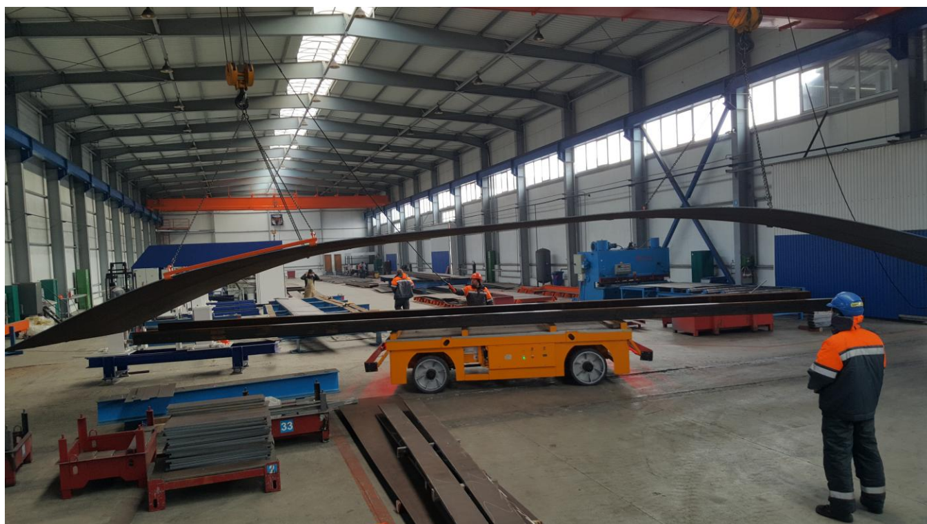
Фото №37. Перемещение длинномерных негабаритных листов 3200 x 26 000 мм двумя кранами и их укладка на самоходную передвижную тележку для межцехового перемещения.
