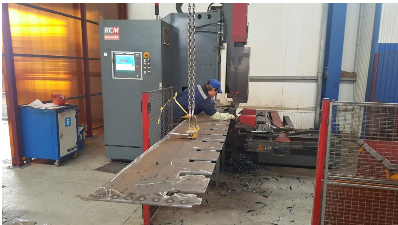
Фото №51. Загрузка-разгрузка листовых заготовок выполняется с помощью магнитного захвата.
