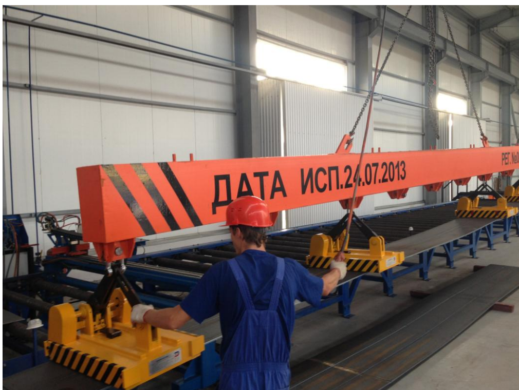
Фото №34. Траверса для перемещения плоских листов грузоподъемностью 8 тонн.
