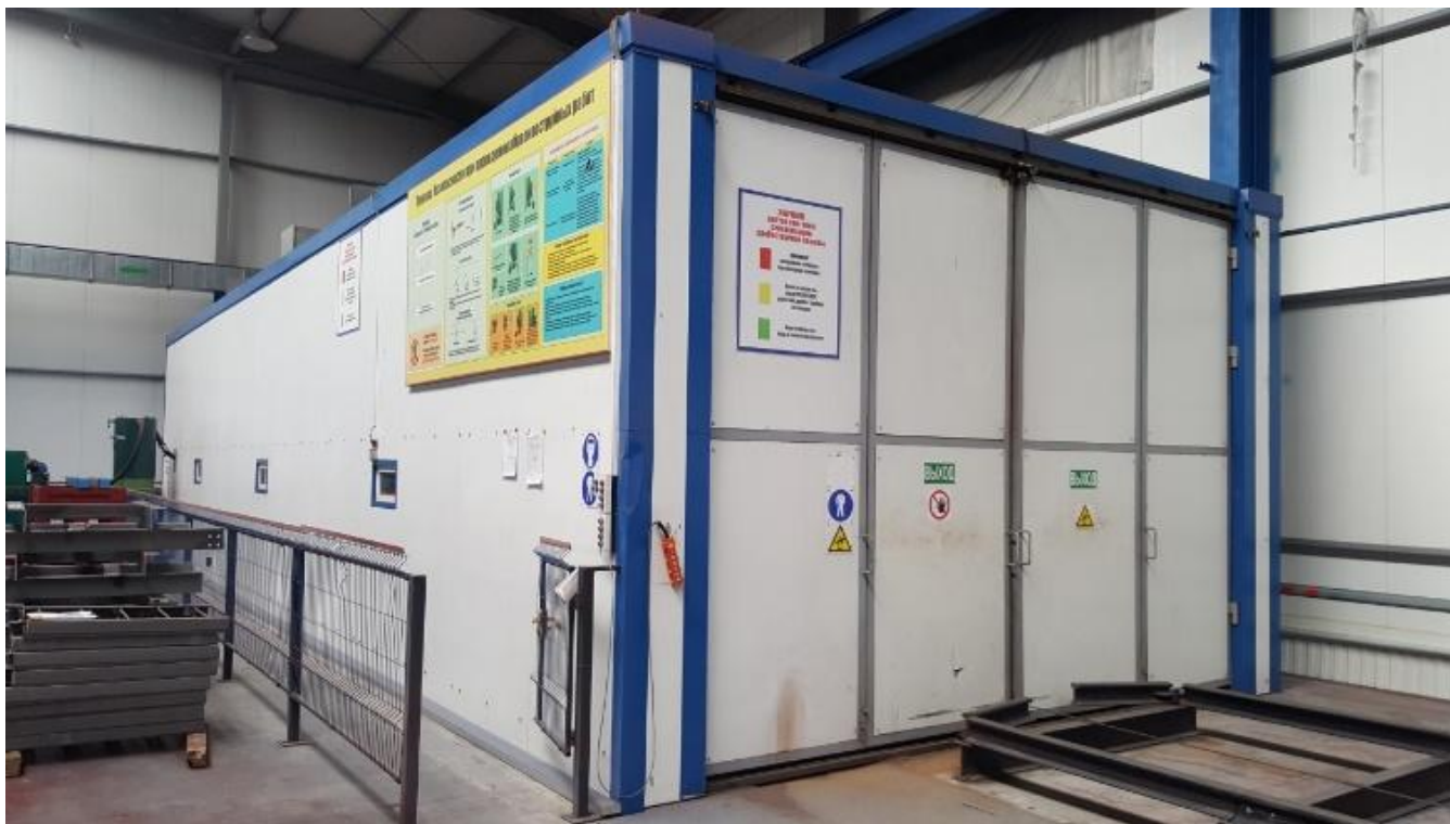
Фото №50. Камера дробеструйной обработки металлоконструкций.
