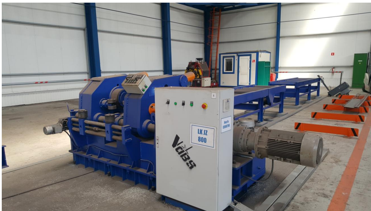
Фото №51. Машина правки «грибовидности» полок балок СИГ-800-50Э
