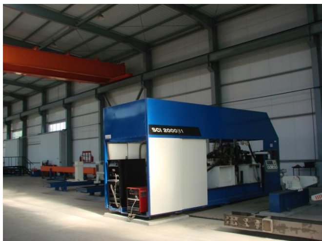
Фото №51. В состав линии входит станция сборки, сварки, кантователь на 180° и станция правки «грибовидности» полок.
