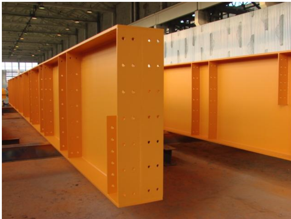
Фото №51. Балка для морской эстакады. Пятислойная окраска специальной системой.
