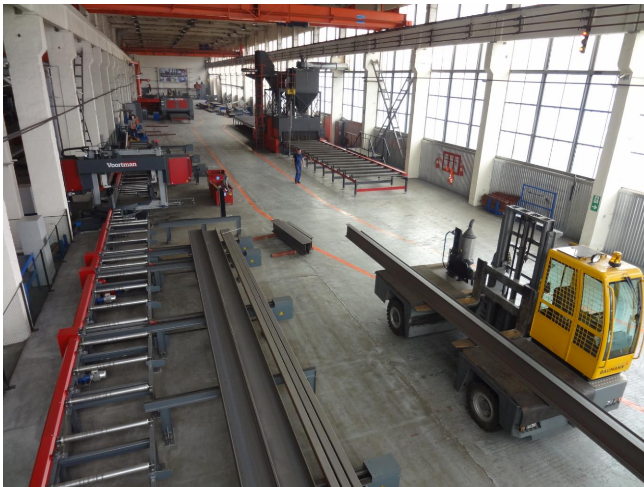
Фото №51. Вилочный погрузчик с боковой загрузкой “Bauman” предназначен для транспортировки длинномерных профилей и готовых отправочных марок.
