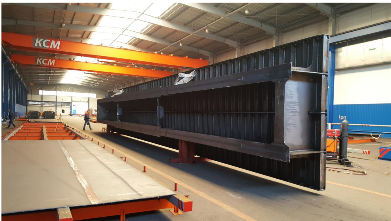
Фото №51. Хребтовая балка для Крымского моста).
