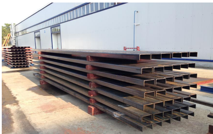
Фото №5. Сортовой, фасонный и листовый прокат укладывается в пакеты в соответствии со схемой раскладки (смотри рис. № ??? и №???) стропальщиками склада металлопроката.
