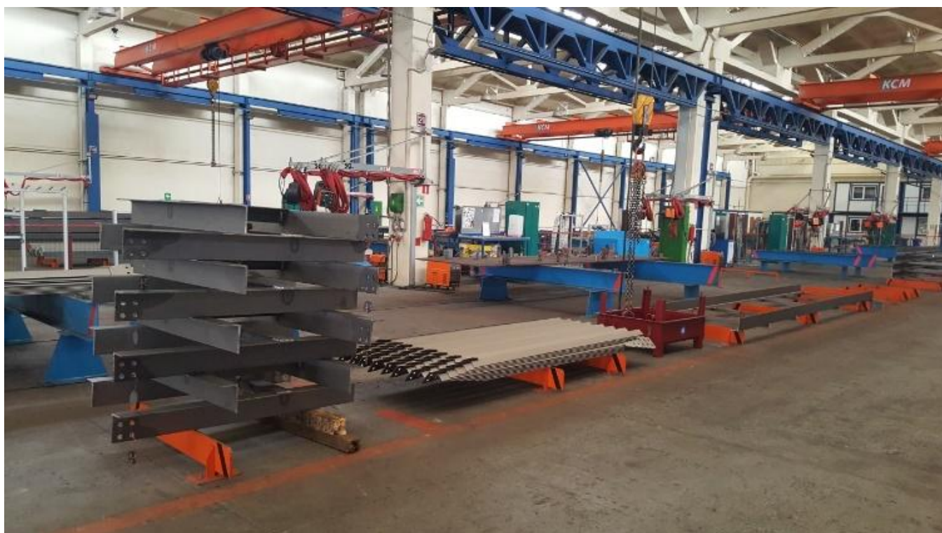
Фото №23. Собранные отправочные марки укладываются в пакет на лаги для удобства их дальнейшей транспортировки вилочным погрузчиком без использования ГПМ.
