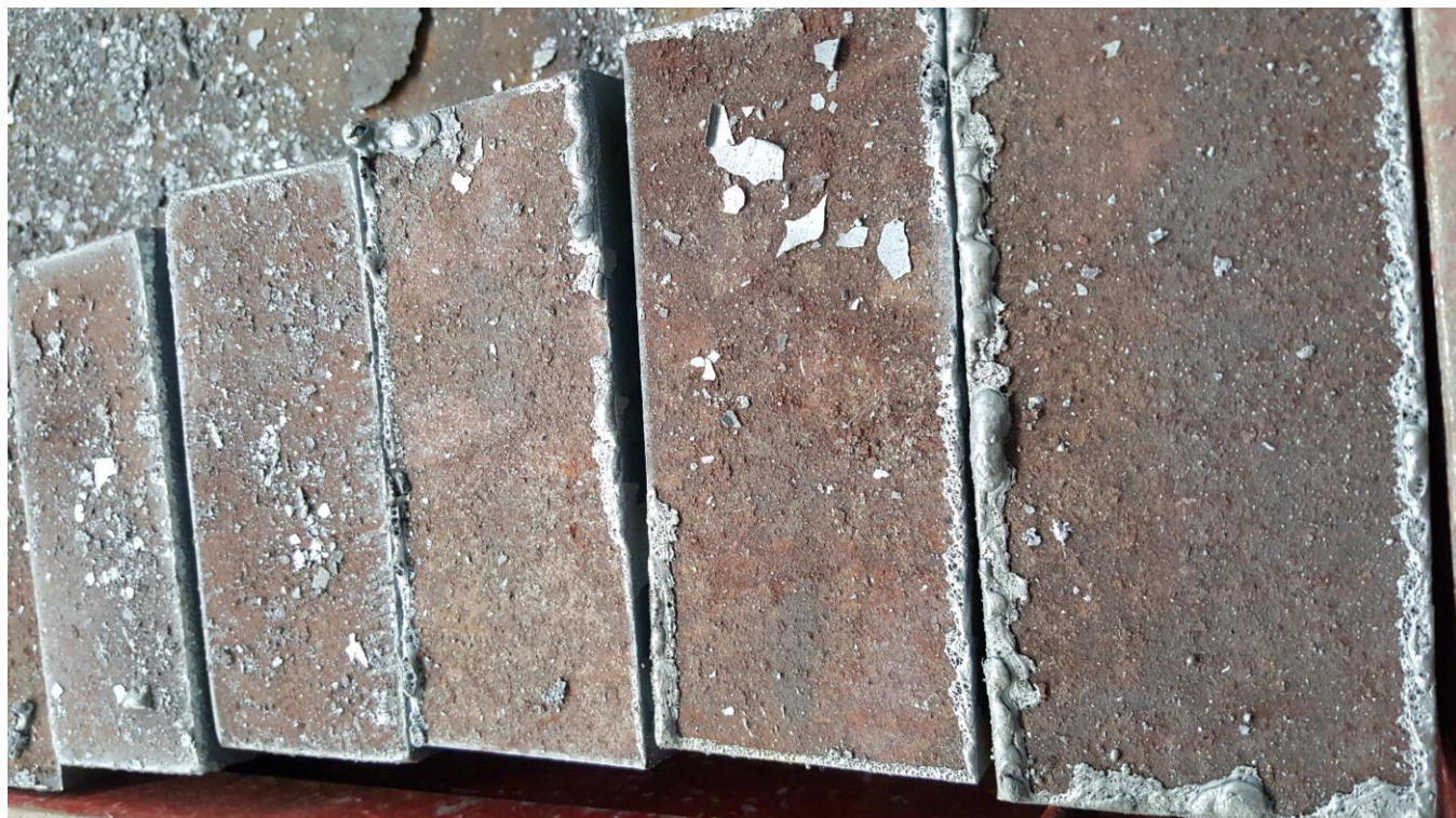
Фото №51. Заготовки после газовой или плазменной резки
