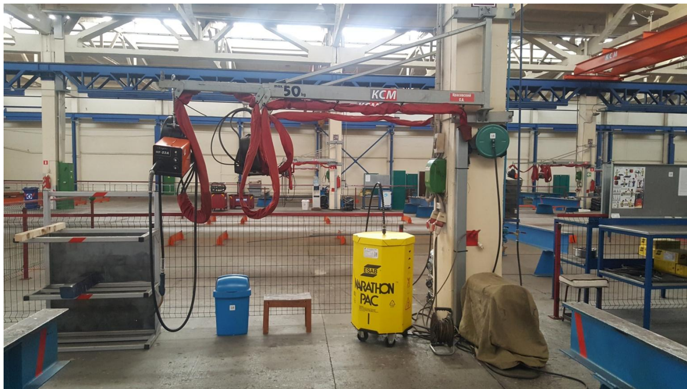
Фото №10. Рабочие посты сварщиков укомплектованы бухтами сварочной проволоки Marathon Pac.
