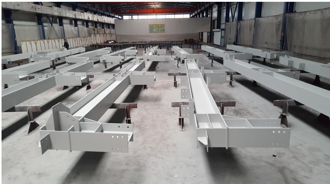
Фото №51. Металлоконструкции дожимной компрессорной станция УКПГ-3С «Заполярная» (ОАО Газпром)
