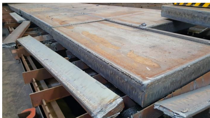
Фото №51. Толщина разрезаемого газом металла до 150 мм.
