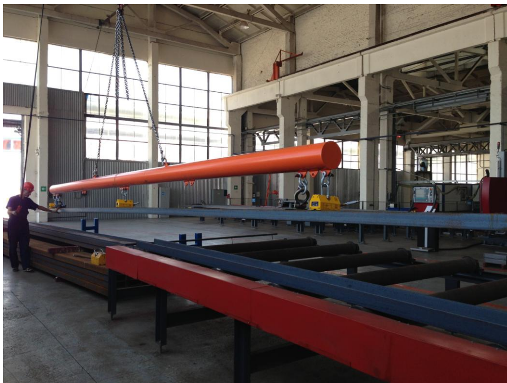
Фото №8 Трубчатая траверса с магнитным и эксцентриковым захватом для фасонного и листового проката
