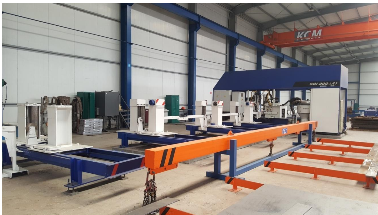
Фото №51. Линия сварки балок SCI 2000.
