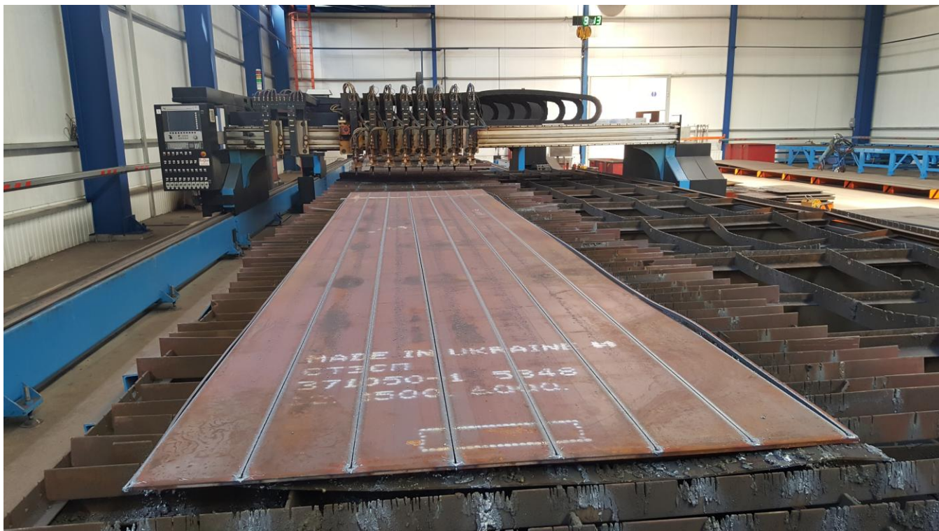
Фото №51. За один проход портала газовой резки можно изготовить до 7 полос (полок и стенок для сварных балок).
