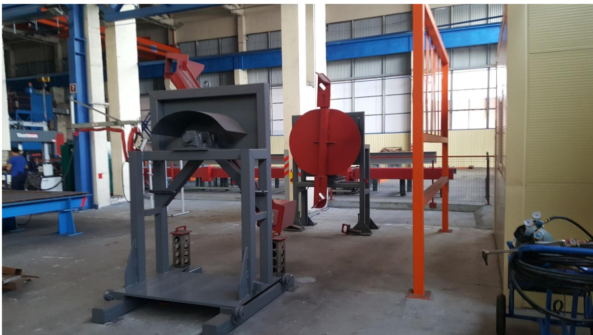
Фото №28. Кондукторы и вращатели для сборки и обварки секций башенного крана.
