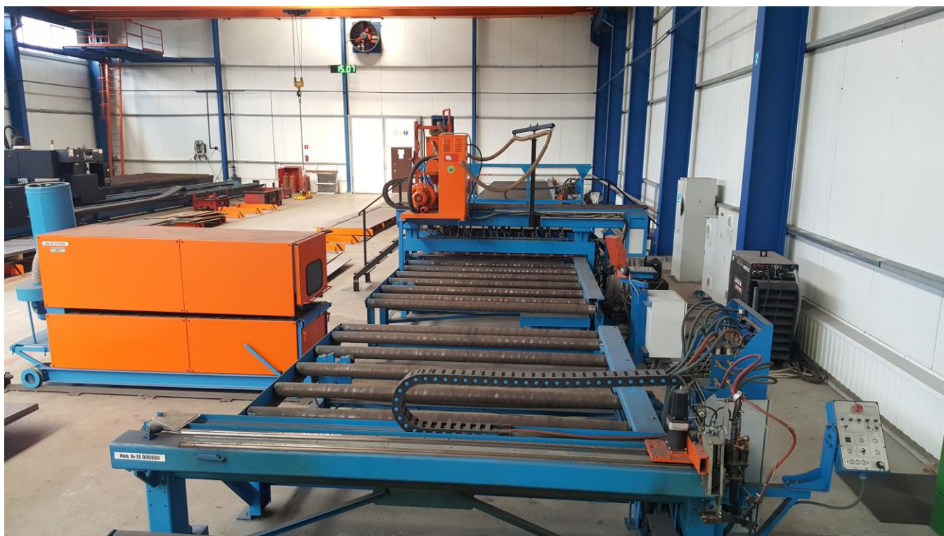
Фото №51. Линия стыковки гладкого листа с максимальной шириной 2500 мм.
