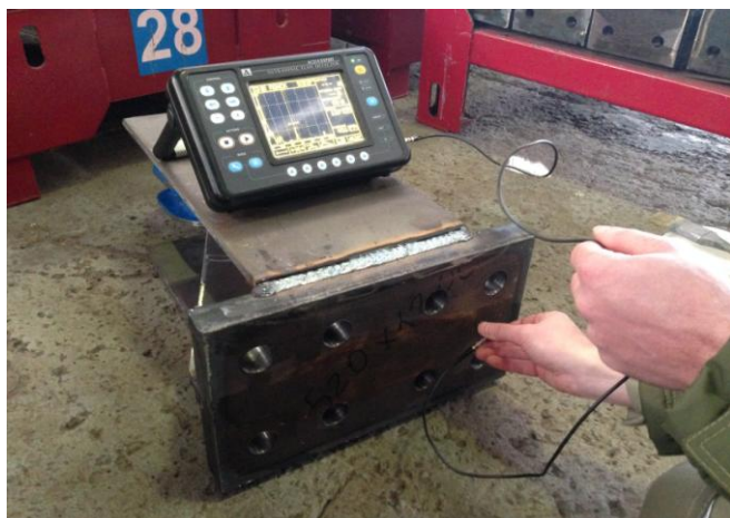
Фото №10. Сварные швы проверяются ультразвуковым дефектоскопом А1214.
