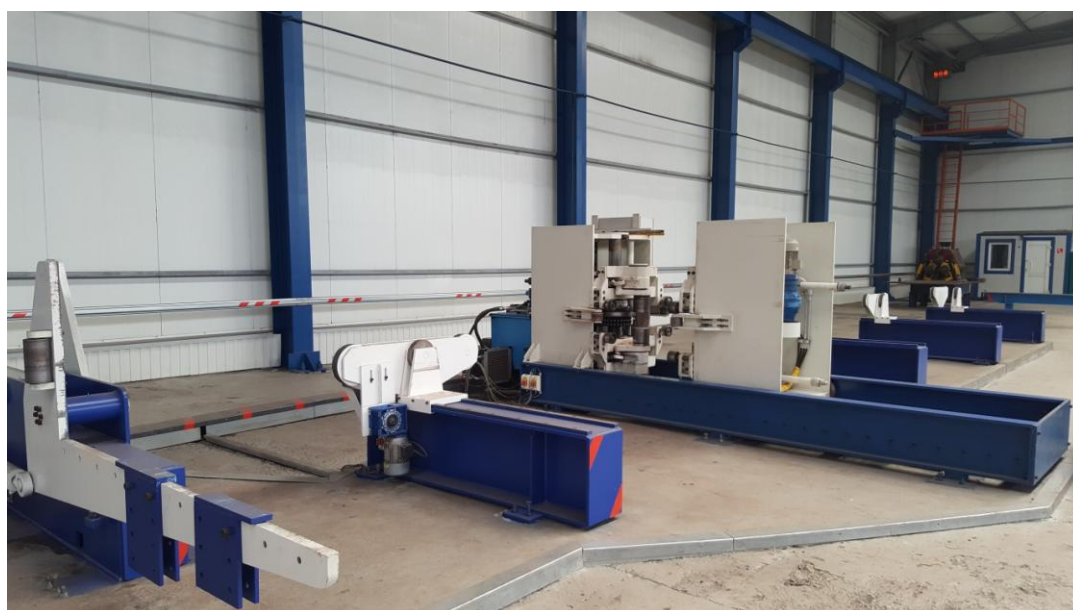
Фото №51. Машина правки «грибовидности» полок балок SFI 2000
