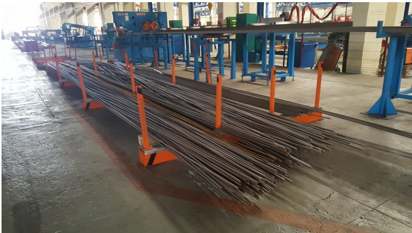
Фото №11. Рабочие места укомплектованы стеллажами для хранения делового отхода металлопроката.
