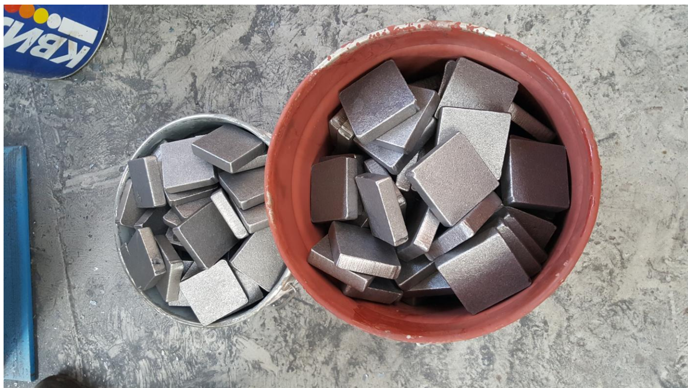
Фото №51. Заготовки после обработки в галтовочном барабане
