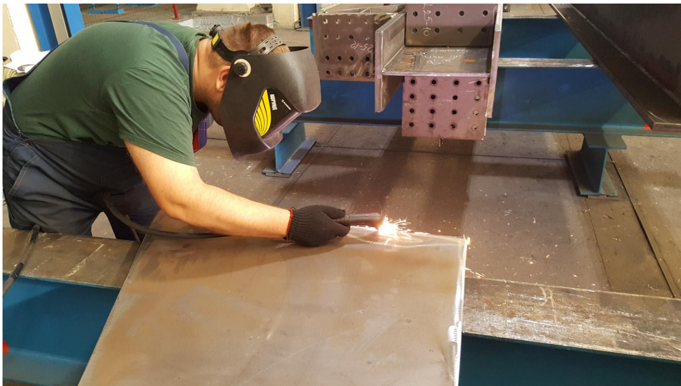
Фото №51. Разделка кромки полосы с помощью Powermax 105 (ручная строжка)
