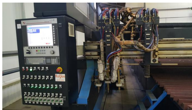
Фото №51. На линии установлены 2 резака X-Bevel для разделки К и Х кромок.
