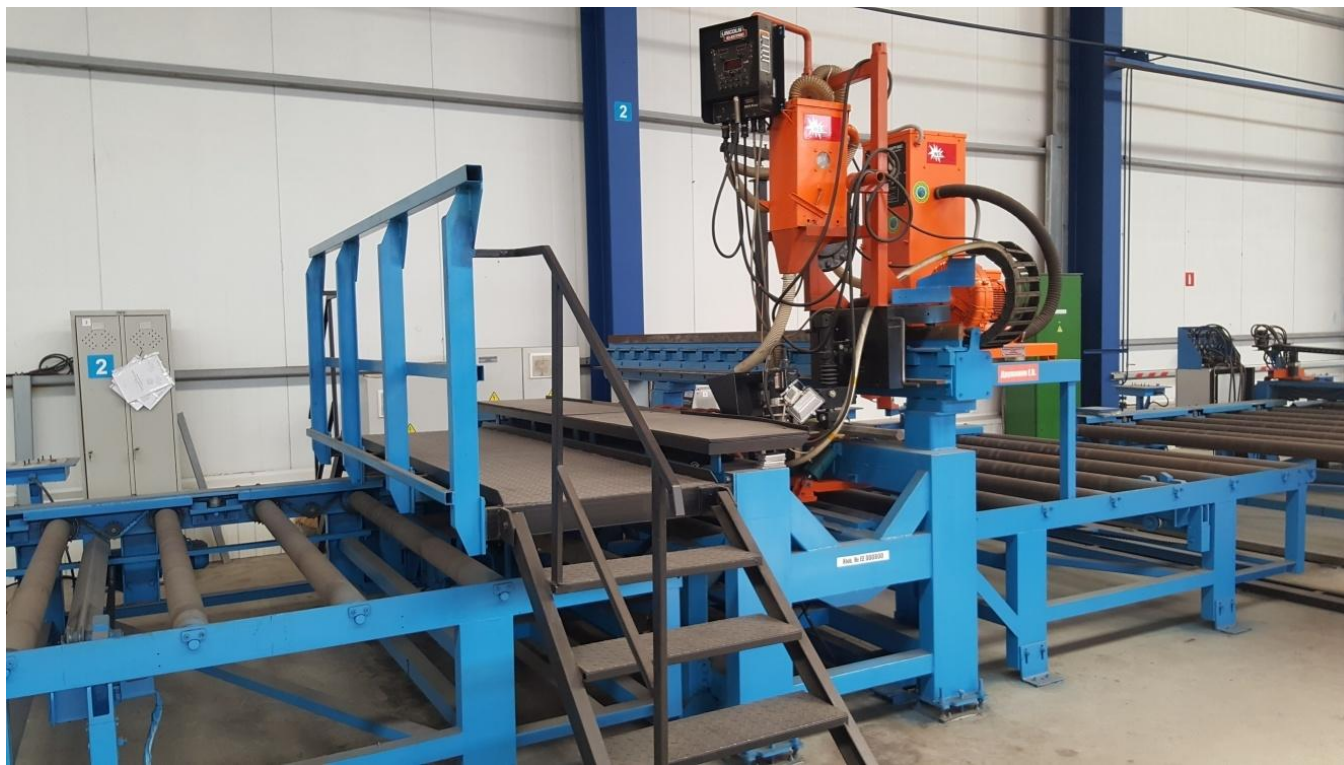
Фото №51. Узел сварки листов под флюсом на базе источника тока Lincoln Electric Power Wave 1000.
