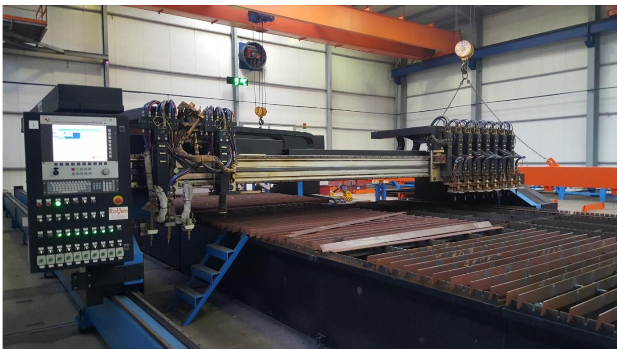
Фото №51. Линия газовой резки с 8-ю газовыми резаками + 2 резака X-Bevel.
