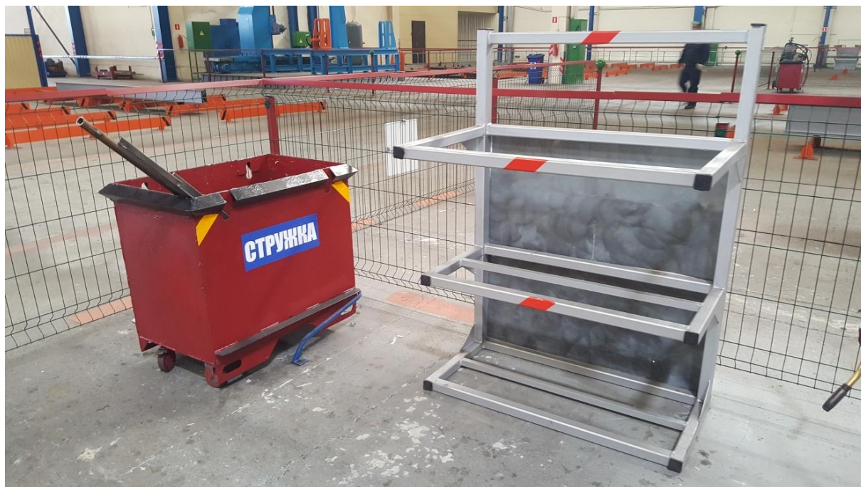
Фото №9. Рабочие места укомплектованы тарой для сбора отходов металлопроката
