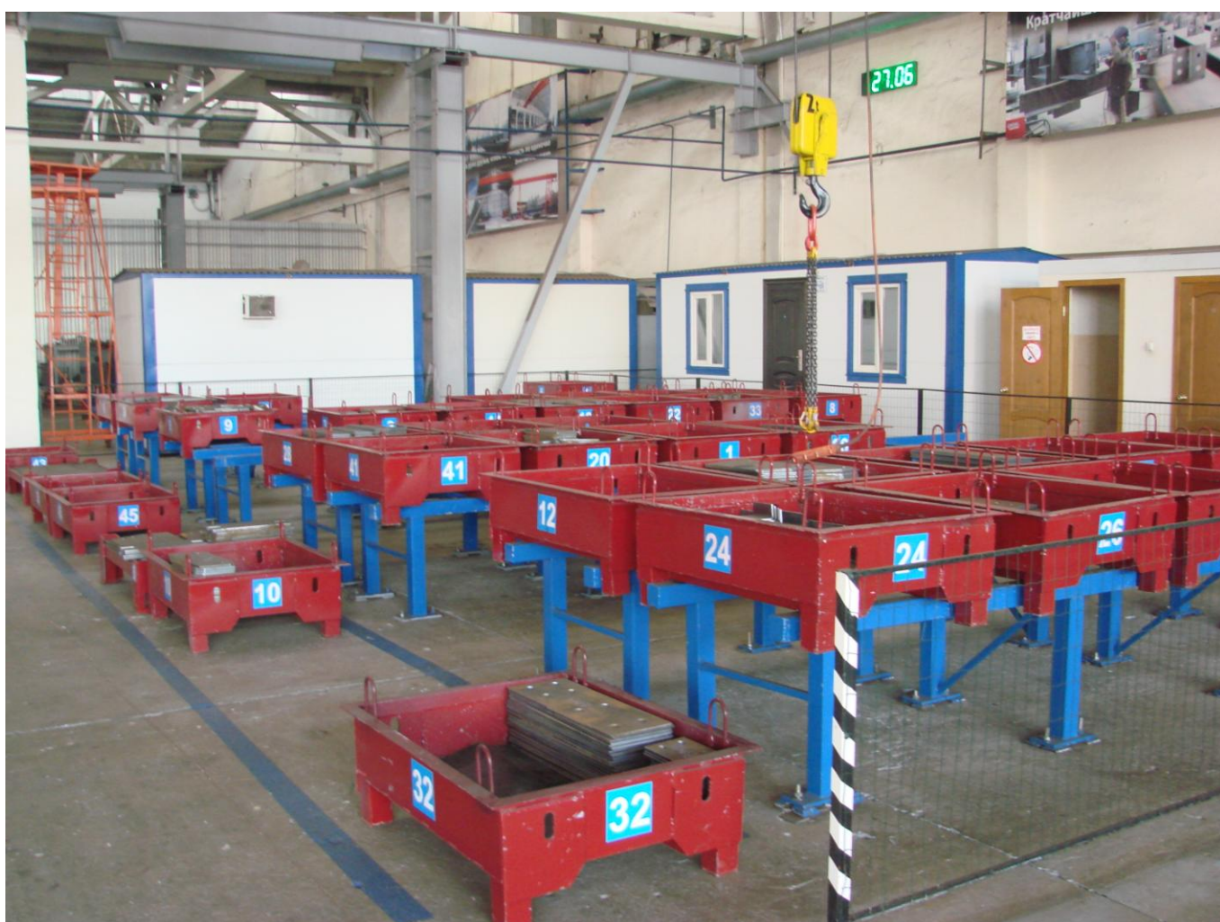
Фото №15. Хранение листовой заготовки в специальной таре в участке комплектации..
